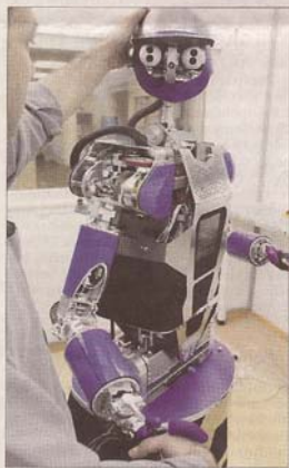
Maschine mit menschlichen Zügen: Forscher der Spitzen-Uni Karlsruhe bauen Roboter. „Armar III“ kann seine Arme bewegen und ansatzweise auch sehen und sprechen. Foto: dpa
