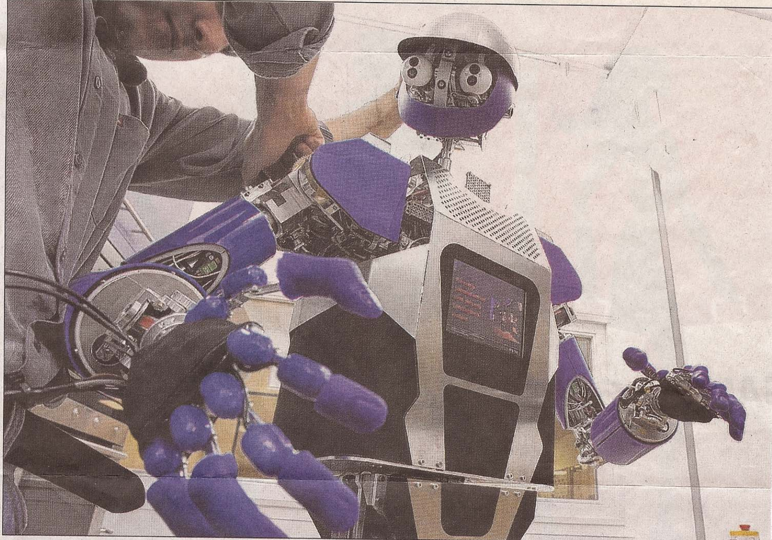
Roboter „Amar III“ kann greifen, sprechen, sehen – und bald auch ein Ei von einem Milchkrug unterscheiden.
